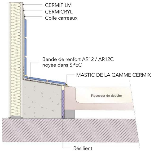
Le joint mastic de liaison avec le receveur peut être remplacé par un profilé d'arrêt de carrelage PVC ou aluminium.
