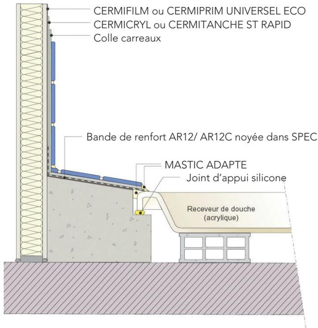
Le joint mastic de liaison avec le receveur peut être remplacé par un profilé d'arrêt de carrelage PVC ou aluminium.
