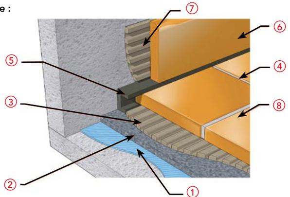
**Attention :** il ne faut jamais de mortier de joint entre le carrelage de sol et la plinthe, la finition ne peut se faire qu'avec un mastic élastomère en cartouche.
