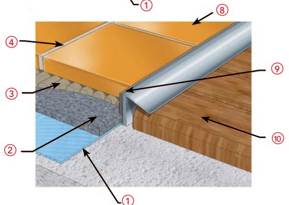
Un fractionnement du carrelage doit être réalisé tous les 8 m dans les couloirs, tous les 40 m<sup>2</sup> pour les autres pièces et aux seuils de porte. Le joint de fractionnement doit être placé sur l'isolant.
