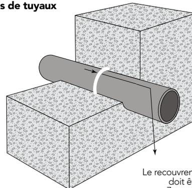
Le recouvrement de béton doit être d'au moins 7 cm des deux côtés
