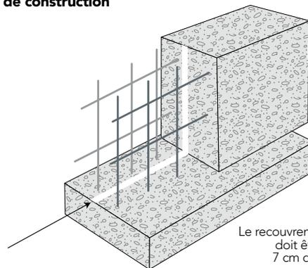
Le recouvrement de béton doit être d'au moins 7 cm des deux côtés
