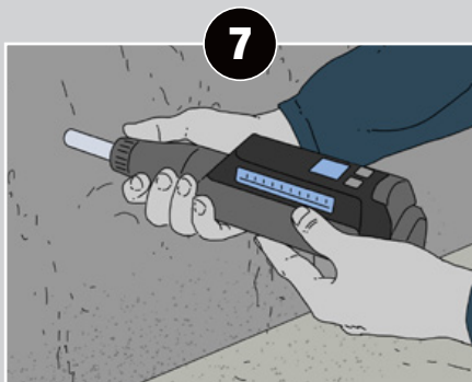
Contrôle de la résistance à la compression du béton par scléromètre
