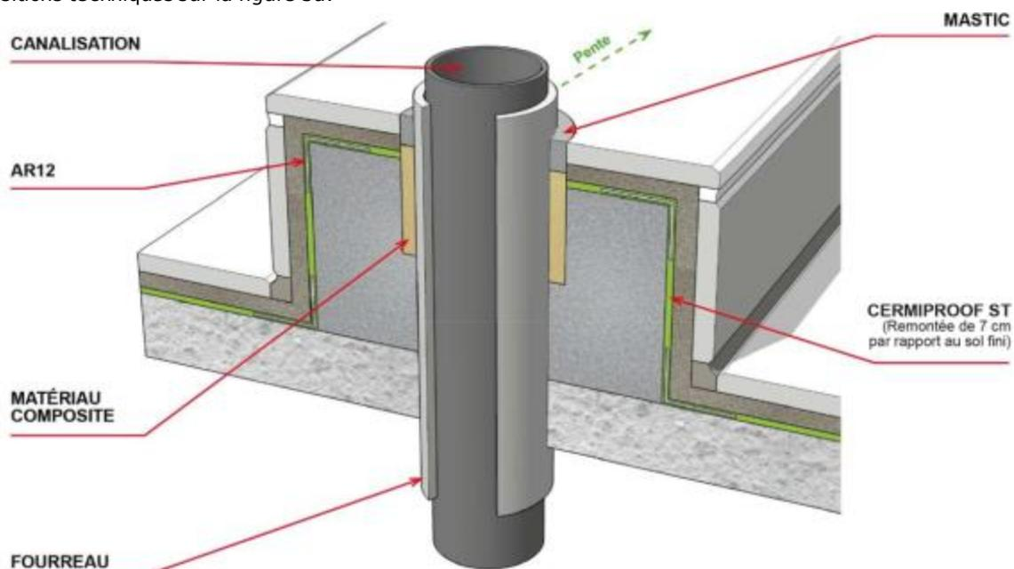
**Figure 3a – Traitement d'une canalisation traversante en sol en pose collée**
