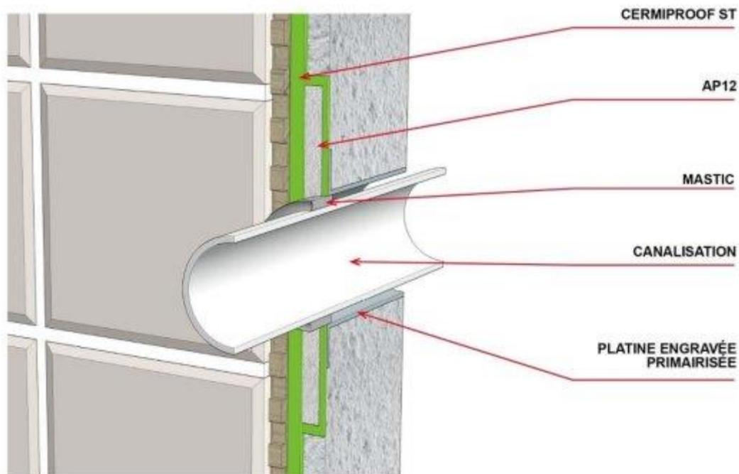
**Figure 4a – Traitement d'une canalisation traversante en mur**
