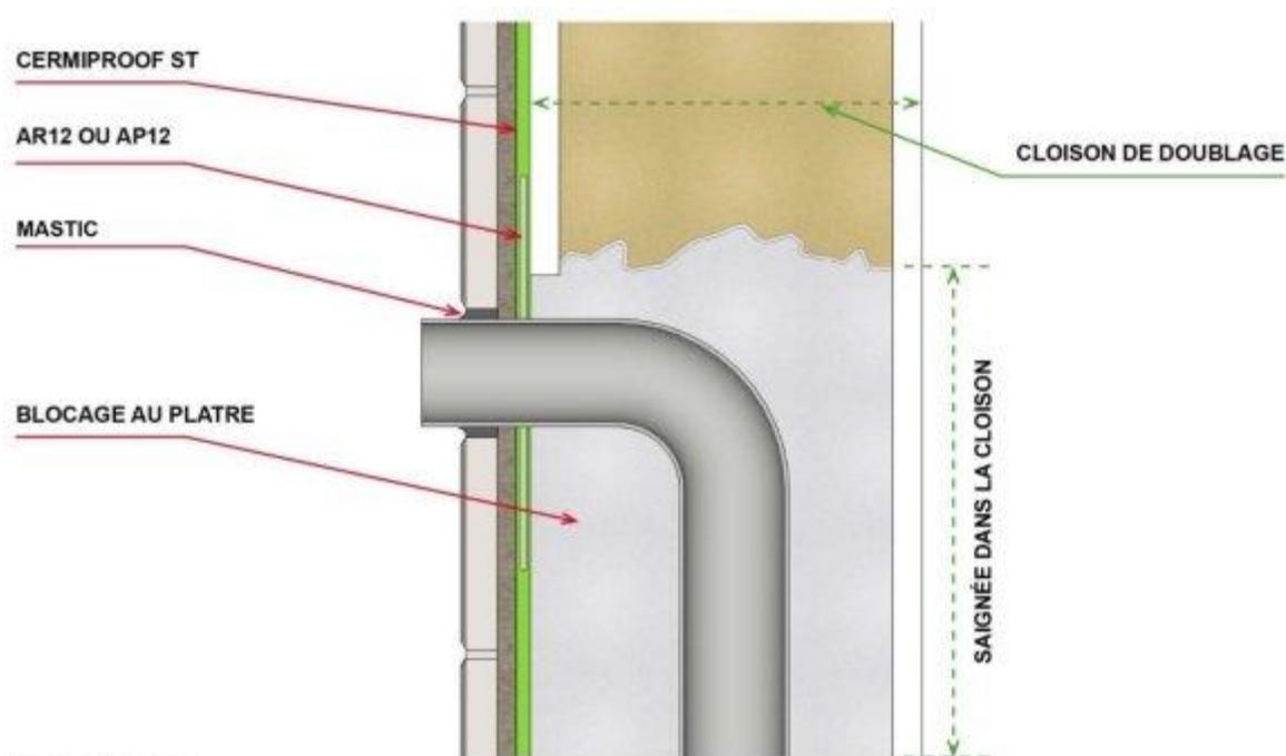
**Figure 4b – Traitement d'une canalisation encastrée en mur**
